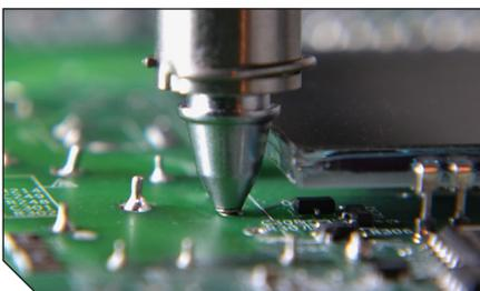
Schmale Entlötspitze für optimale Erreichbarkeit der Lötstelle
