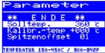
Die Solltemperatur ist die zur Bearbeitung gewünschte Lötspitzentemperatur.
