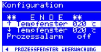
Für das angeschlossene Lötwerkzeug kann ein Temperaturfenster mit einem oberen und unteren Temperaturwert definiert werden.
