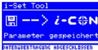
Mit dem i-SET TOOL (Option) wird ermöglicht, die Einstellungen (inklusive Passwort) der Station zu speichern und wieder in die Station zurückzuschreiben. Somit können Sie die Grundeinstellungen schnell auf mehrere Stationen übertragen. Lesen Sie hierzu die Benutzeranleitung zum i-SET TOOL. So nutzen Sie das i-SET TOOL:
