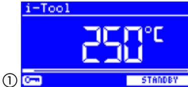
Das Passwort wird im Konfigurationsmodus eingestellt. Ist bereits ein Passwort eingestellt, wird der Code „verdeckt“ angezeigt.
