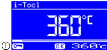
Die Daten der Station können über ein 4-stelliges Passwort (0001-9999) geschützt werden. Dadurch wird verhindert, dass Einstellungen/Änderungen vorgenommen werden können. Werkseitig ist kein Passwortschutz aktiviert, dies wird durch [0000] im Passwordeingabefenster angezeigt.
