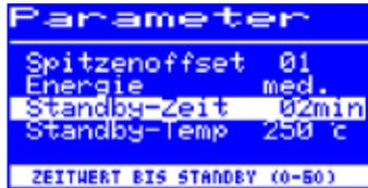
Die Standby-Zeit ist die Zeitspanne vom letzten Arbeiten mit dem Lötwerkzeug bis zu dem Zeitpunkt, an dem die Standby Temperatur aktiviert wird. Der Einstellbereich beträgt 20 Sekunden bis 60 Minuten. Die Eingabe von [0] deaktiviert die Standby Funktion.
