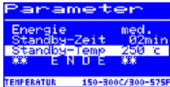
Dies ist die Lötspitztemperatur bei Arbeitspausen. Sie wird automatisch nach Ablauf der [Standby Zeit] aktiviert. Durch das Absenken der Temperatur wird Energie gespart und die Lebensdauer von Spitze und Heizkörper erhöht.
