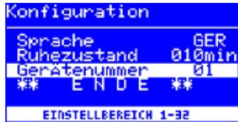
Diese Funktion wird nur dann benötigt, wenn die i-CON 1 mit der seriellen Schnittstelle (Option) ausgerüstet ist. Damit der PC die angeschlossene Station korrekt zuordnen kann, müssen Sie zur Identifizierung eine eindeutige Gerätenummer einstellen.
