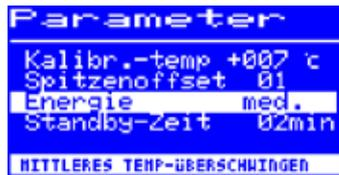
Diese Funktion gestattet es dem Anwender, das Regelverhalten der Station zu beeinflussen, wodurch das Auf- und Nachheizverhalten der Station auf das jeweilige Einsatzgebiet angepasst werden kann. Es sind drei Einstellungen möglich: [high], [med.] und [low].
