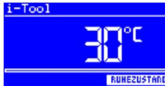
Die einstellbare Shutdown-Funktion (Ruhezustand) dient der Energieeinsparung und der Verlängerung der Lebensdauer von Lötspitzen und Heizkörper. Im Ruhezustand kühlen die Werkzeuge bis zur Raumtemperatur ab. In der unteren Displayzeile wird dann der Text [Ruhezustand] angezeigt. Sie können den Ruhezustand jederzeit beenden, indem Sie den i-OP betätigen.
