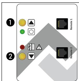
Все настройки устройства выполняются с помощью двух кнопок на панели. Верхняя кнопка обозначена символом ①, нижняя - символом ②. Кнопка подсвеченна, когда находится в активном состоянии. В пассивном состоянии подсветка кнопки отключена.
