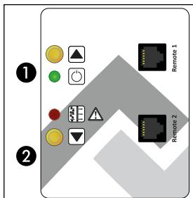
Alle Einstellungen am Gerät werden über die beiden Drucktaster am Display vorgenommen. Der obere Drucktaster wird im Folgenden als Button **1** und der untere Drucktaster als Button **2** bezeichnet. Die Buttons sind aktiv, solange sie beleuchtet sind und inaktiv solange sie nicht beleuchtet sind.
