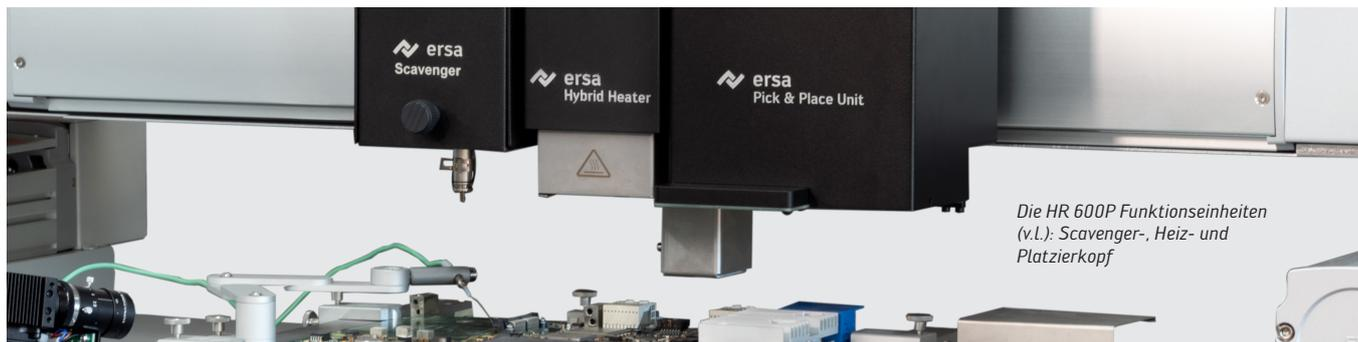
Die HR 600P Funktionseinheiten (v.l.): Scavenger-, Heiz- und Platzierkopf
