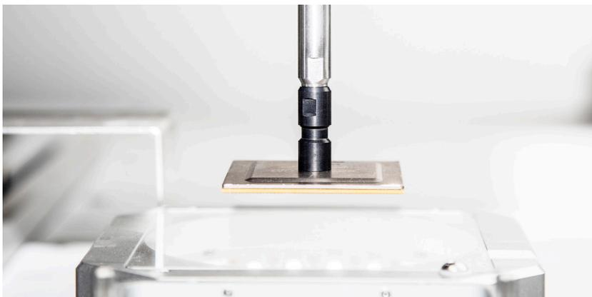
Metallisches BGA über dem Licht-Dome zur Erfassung der Bauteilanschlüsse
