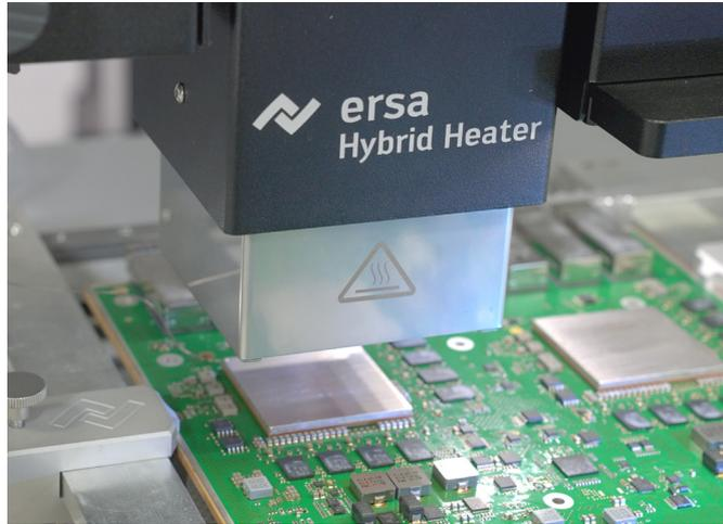
Homogene und reproduzierbare Bauteilerwärmung durch den Hybrid-Heizkopf
