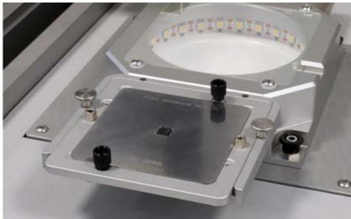
Abb. 38: Beispielabbildung: Das mit Lotpaste bestrichene Bauteil ist in der Print-Schablone eingesetzt und wird in den Schablonenrahmen eingeschoben
