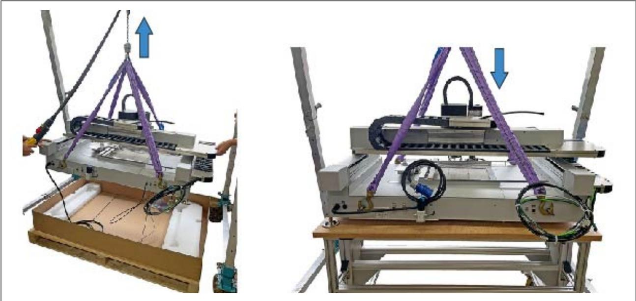
Abb. 4: Das Reworksystem mit dem Kran an den Ösen anheben und auf dem Tisch absetzen
