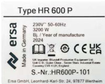
Abb. 45: Beispiel für das Typenschild einer Maschine. Die Angaben sind nicht identisch mit dem Typenschild an Ihrer Maschine.
