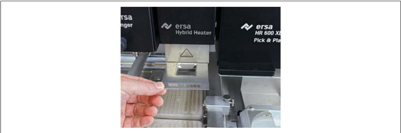
Abb. 13: Ein Luftleitblech am Heizkopf einschieben
