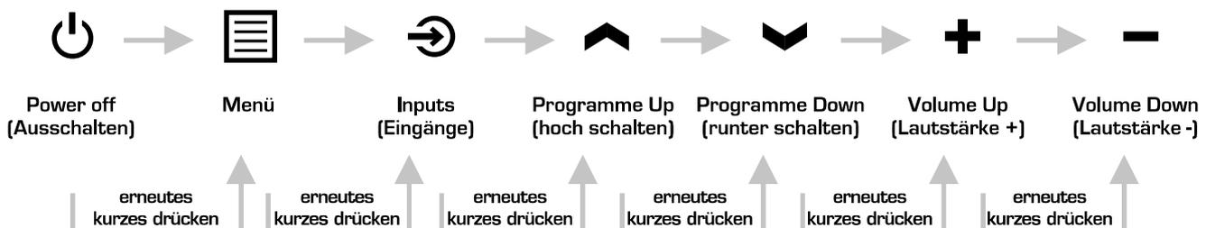
Um die Menüpunkte (Power off, Menü, Inputs, Programme Up, Programme Down, Volume Up, Volume Down) zu verändern, halten Sie die **POWER-/MULTIFUNKTIONSTASTE** für ca. 2 Sekunden gedrückt.
