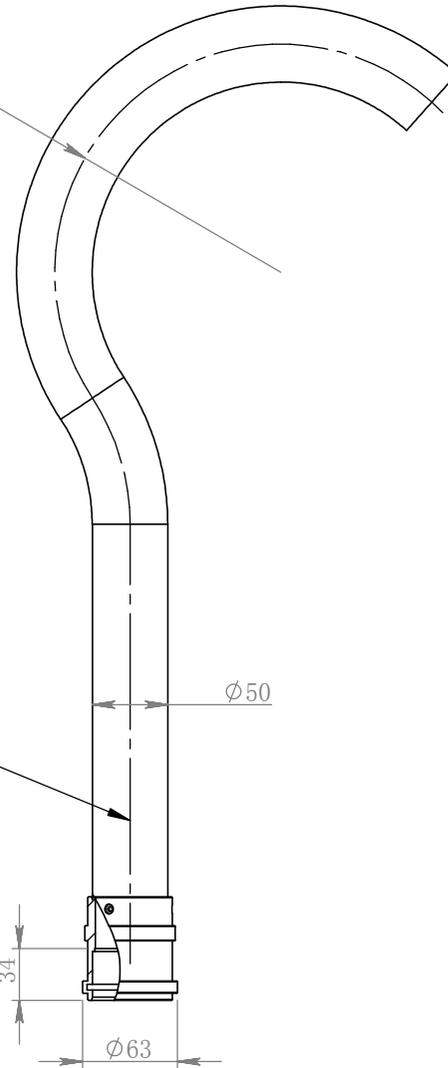
可弯曲绕型管长800毫米
